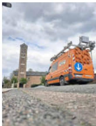
Ab April 2024 sind spezielle Messfahrzeuge von der Firma LEHMANN + PARTNER GmbH aus Erfurt im Einsatz, die u.a. mit hochauflösenden Kameras und verschiedenen Laserscannern ausgestattet sind. Diese Fahrzeuge werden über die nächsten Monate mehr als 4.500 km Straßen digital erfassen und vermessen. Durch die Nutzung der hochauflösenden und georeferenzierten Bilder sowie der Laserscandaten erhalten die
